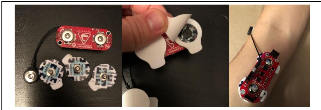
รูปที่ 3.5 การติด MyoWare เข้าผิวหนังของผู้ทดลอง
