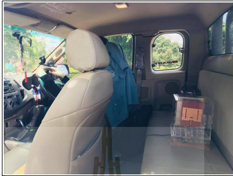
รูปที่ 5.8 การติดตั้งอุปกรณ์โครงข่ายอินเทอร์เน็ตสรรพสิ่งที่ใช้งานแถบความถี่แคบภายในยานพาหนะ ขณะทำการวัดทดสอบ
