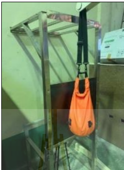
รูปที่ 3.2 ชุดทดสอบความแข็งแรงของผนังเมื่อถูกกระแทกด้วยวัสดุอ่อนนุ่มขนาดใหญ่
