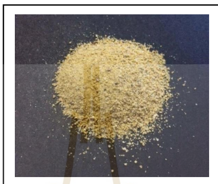
รูปที่ 3.2 ทรายที่ผ่านกระบวนการร่อนด้วยตะแกรงมาตรฐาน
