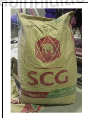
รูปที่ 3.1 ปูนซีเมนต์ปอร์ตแลนด์ประเภทที่หนึ่ง
