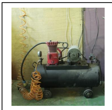
รูปที่ 3.7 เครื่องอัดอากาศ
