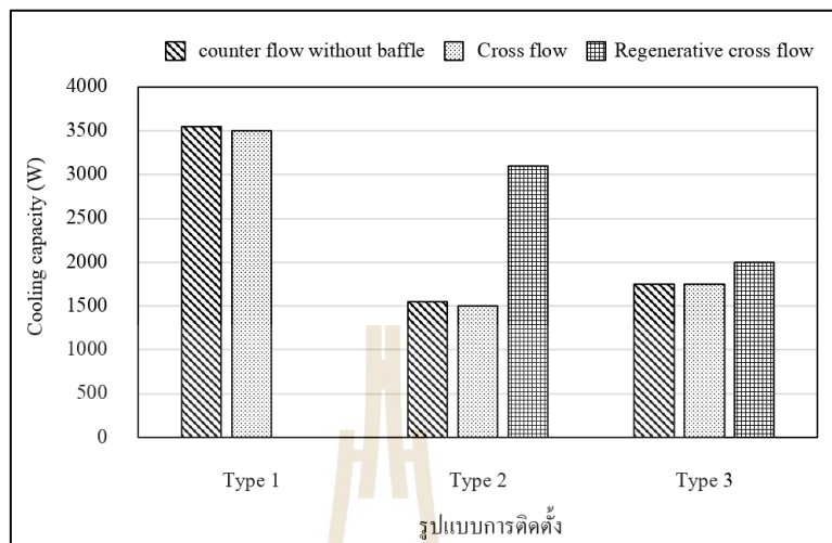
รูปที่ 4.79 ขนาดของแกนทำความเย็นสำหรับระบบทำความปรับอากาศแบบไฮบริดสำหรับร้านสะดวกซื้อ
