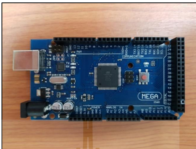
รูปที่ 3.10 อุปกรณ์บอร์ดควบคุมขนาดเล็ก Arduino MEGA
