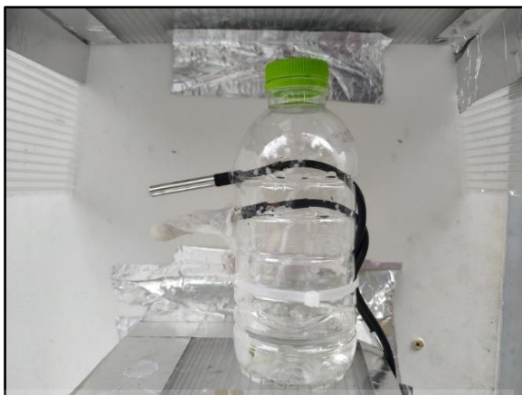
รูปที่ 3.20 ลักษณะเซ็นเซอร์วัดอุณหภูมิกระเปาะแห้งและกระเปาะเปียก
