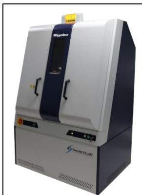
รูปที่ 3.22 เครื่องวิเคราะห์การเลี้ยวเบนของรังสีเอ็กซ์ (X-ray diffractometer) ยี่ห้อ Rigaku รุ่น Smart Lab
