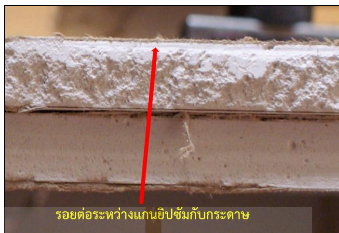
รูปที่ 2.46 บริเวณรอยต่อของแกนยิปซัมและกระดาศ คือ จุดที่มีปริมาณแฉังมากที่สุด
