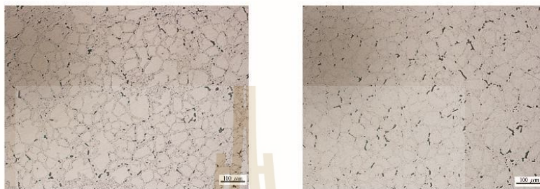
(ก) ครึ่งที่หนึ่งที่อุณหภูมิ 110 °C เวลา 8 ชั่วโมง (ข) ครึ่งที่สองที่อุณหภูมิ 170 °C เวลา 1 ชั่วโมง รูปที่ 7 โครงสร้างจุลภาคของชิ้นงานที่ผ่านการบ่มแข็งครึ่งที่หนึ่ง และครึ่งที่สอง
