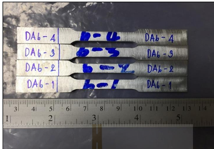
รูปที่ 3.12 ชิ้นงานทดสอบการทนต่อแรงดึง
