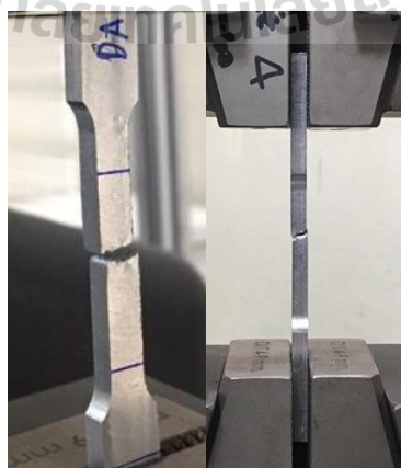
รูปที่ 4.30 ลักษณะรอยขาดของชิ้นงานค่าความต้านแรงดึงสูง (ซ้าย) ค่าความต้านแรงดึงต่ำ (ขวา)
