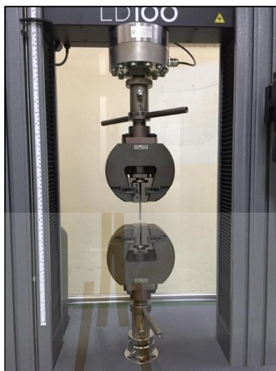
รูปที่ 3.8 เครื่องทดสอบความต้านแรงดึง (LAB Tensile Test, SUT)
