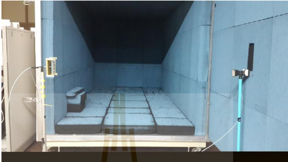
รูปที่ 5.5 ลักษณะการติดตั้งสายอากาศเพื่อทดสอบอัตรายาย
