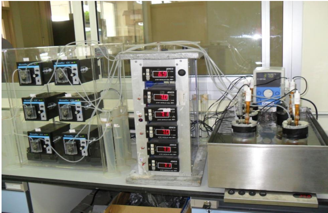
รูปที่ 2.1 แสดงขวดทดลองขนาด 500 mL ในอ่างควบคุมอุณหภูมิที่เชื่อมต่อกับระบบควบคุมค่าความเป็นกรด-ด่าง (pH) ในระหว่างการหมักอย่างอัตโนมัติ
