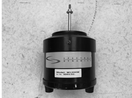
รูปที่ 17 Shaker. Spectrum Dynamics Model M1200W
