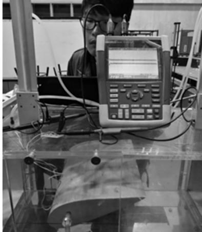
รูปที่ 20 การติดตั้ง Oscilloscope
