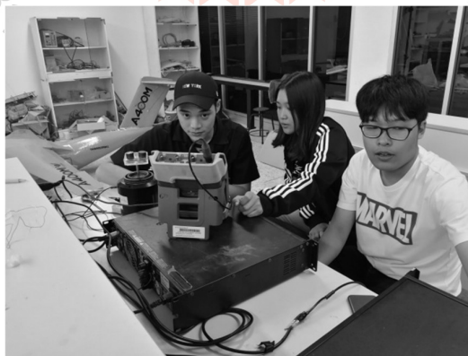
รูปภาพ 28 การทดลองกระตุ้นวัสดุเพียโซด้วยเครื่องเขย่า
