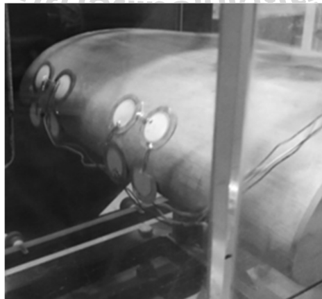
รูปที่ 19 การติดตั้งวัสดุเพียโซลงบนผิวปีกอากาศยาน
