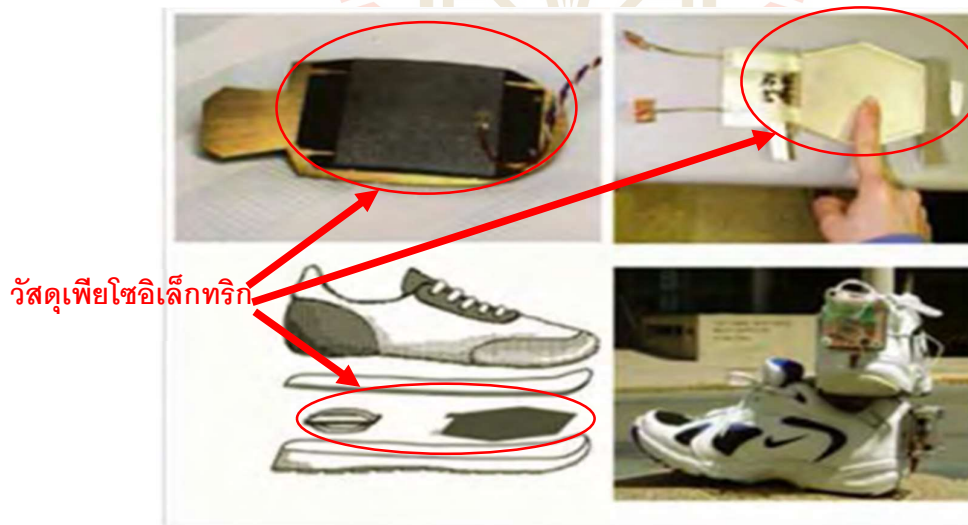
รูปที่ 3 ตัวอย่างการใช้งานวัสดุเพียโซเพื่อกักเก็บพลังงานไฟฟ้าจากรองเท้า
