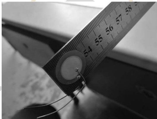
รูปที่ 8 วัสดุเพียโซที่ติดตั้งบนคาน
