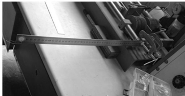
รูปที่ 9 การติดตั้งคานกับเครื่องวัดการสั่นแบบอิสระ (1)
