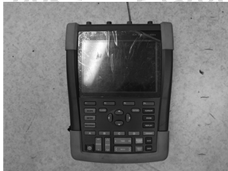
รูปที่ 15 Oscilloscope. Fluke 190-204 Scopemeter
