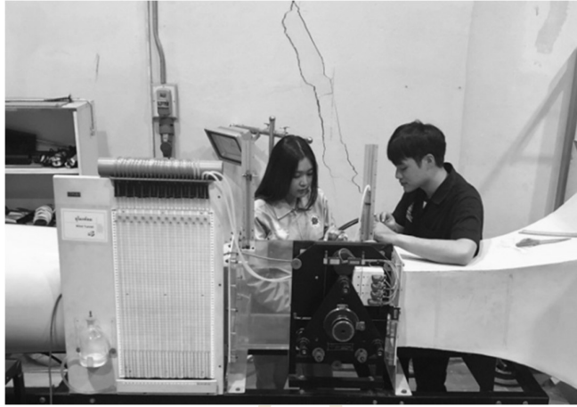
รูปภาพ 26 การทดลองกระตุ้นวัสดุเพียโซในอุโมงค์ลม
