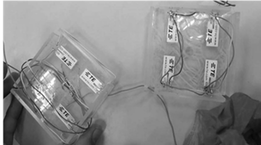
รูปที่ 13 วัสดุเพียโซแบบเซรามิกและพอลิเมอร์ที่ต้องวงจรแบบขนานและอนุกรม
