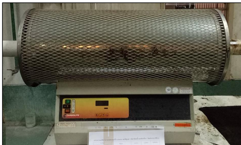
รูปที่ 3.5 เตาเผาแบบท่อแนวนอน (Tube Furnace รุ่น CTF 12/75/700/201 - ยี่ห้อ Carbolite, UK)
