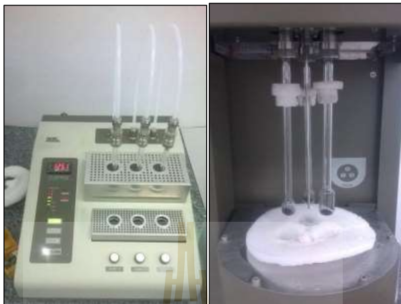
ภาพที่ ข.9 การ degassesภาพที่ ข.10 เอาตัวอย่างเข้าเครื่องวิเคราะห์
