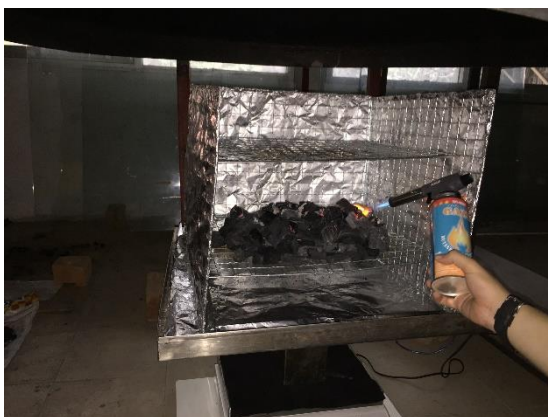
รูปที่ 3.17 การจุดไฟถ่านที่ผ่านการชั่งน้ำหนักด้วยหัวฟันทไฟ (Torch)
