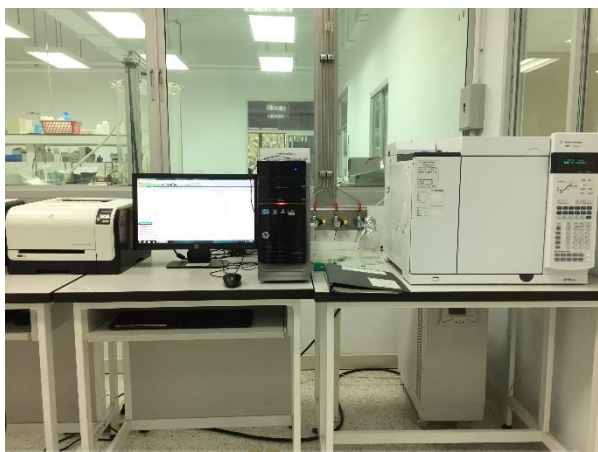
รูปที่ 3.10 เครื่องแก๊สโครมาโทกราฟี ชนิดเฟรมไอออไนเซชัน (GC-FID) (Agilent 7890, USA)
