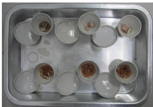
รูปที่ 3.15 เปิดฝาด้วยกระเบื้องที่มีตัวอย่างก่อนนำเข้าอบได้ความชื้นในตู้อบลมร้อน
