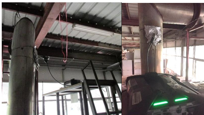
รูปที่ 3.19 การตรวจวัด CO 2 ความเร็วลม และอุณหภูมิภายในปล่องด้วยเครื่อง Testo® 350
