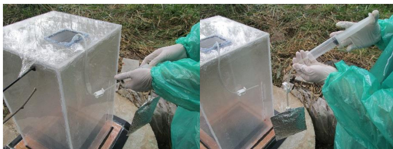
รูปที่ 3.9 การเก็บตัวอย่างแก๊สมีเทนจากกล่องแบบปิดและถ่ายตัวอย่างสู่ถุงเก็บแก๊ส
