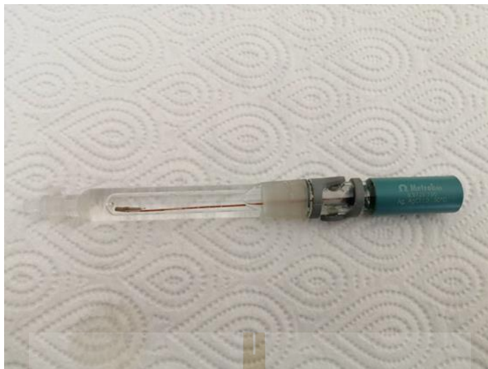
รูปที่ 3.13 อิเล็กโทรดอ้างอิง (Ag/AgCl 3.0M KCl)
