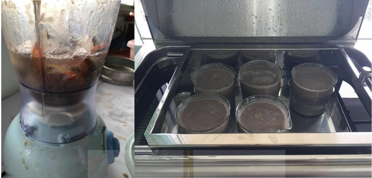
ภาพที่ 13 ปลายุกหั่นและปั่นผสมกับสารละลาย pepsin 0.25 % และเมื่อปั่นละเอียดแล้วตัวนำไป incubate ใน water bath ที่อุณหภูมิ 37 องศาเซลเซียส ทิ้งไว้ประมาณ 1-2 ชั่วโมง
