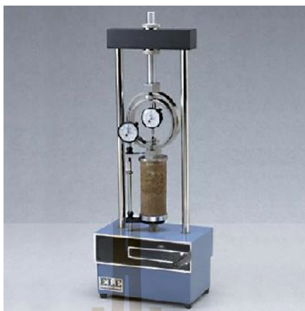
รูปที่ 2.13 เครื่องทดสอบ Unconfined Compressive Strength
