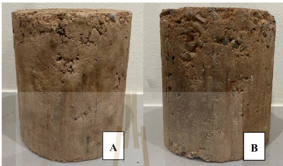
รูปที่ 4.8 ตัวอย่างการสูญเสียน้ำหนักต่ออายุการใช้งานสภาวะเปียกสลับแห้งของดินซีเมนต์ที่ผสมน้ำยางพาราที่อัตราส่วนน้ำต่อน้ำยางพาราธรรมชาติร้อยละ 80:20 (A) และดินซีเมนต์ที่ไม่ผสมน้ำยางพาราธรรมชาติ (B) ที่ 1 รอบอายุการใช้งาน
