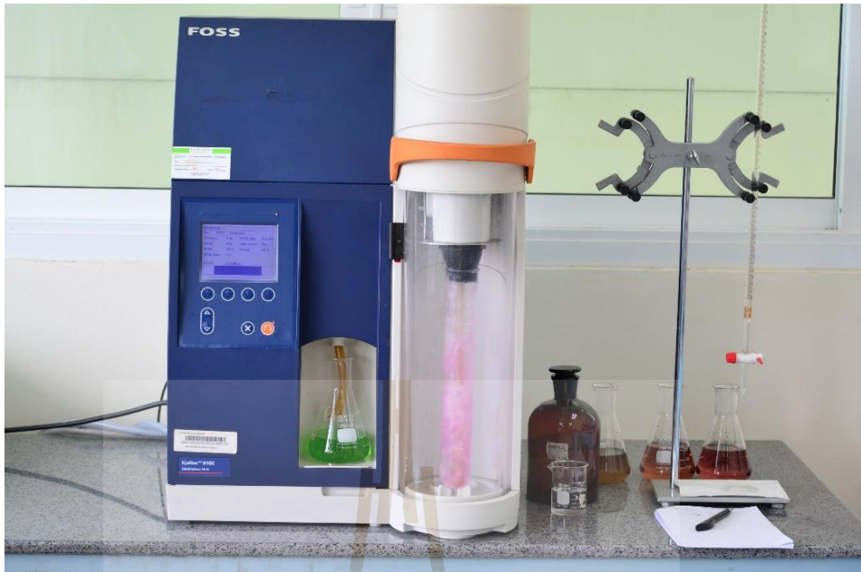
รูปที่ ๑.1 การวิเคราะห์แอมโมเนียไนโตรเจน ( \text{NH}_3\text{-N} ) ด้วยเครื่องกลั่นไนโตรเจน (Distilling unit)
