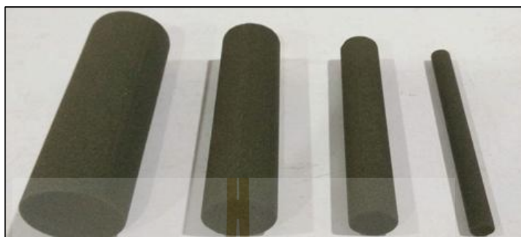
รูปที่ 3.6 ไส้แบบ AM ขนาด 0.5 1.0 1.5 และ 2.0 นิ้ว
