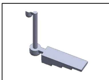
รูปที่ 3.2 แสดงการออกแบบชิ้นงานแบบหล่อทรายสามมิติด้วยโปรแกรม Solidworks
