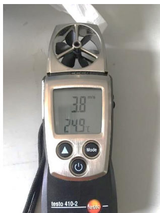
รูปที่ 3.26 Vane anemometer รุ่น testo 410-2
