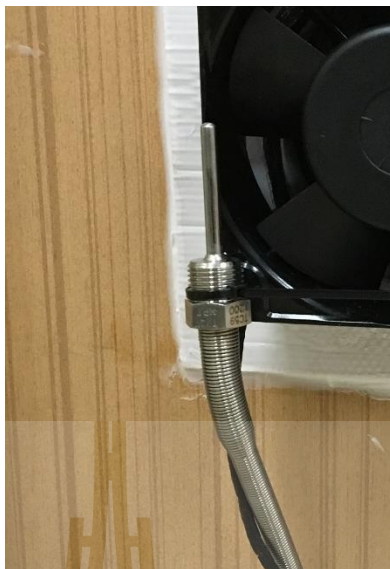
รูปที่ 3.23 Thermocouple type T
