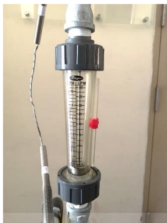
รูปที่ 3.27 Rotameter ใช้วัดอัตราการไหลสารคัดความชื้น
