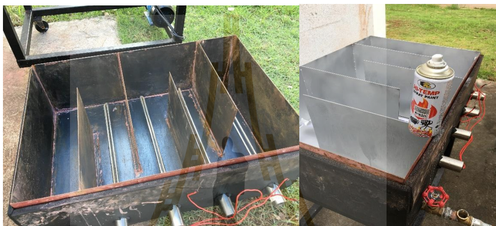
รูปที่ 3.19 การปรับปรุง Hot water bath เพื่อป้องกันสนิม
