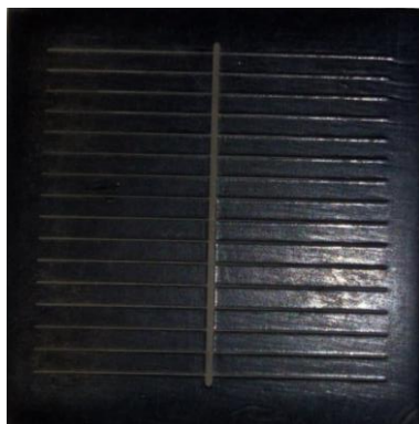
รูปที่ 4.4 แผ่น Flash foam ที่มีลวดลายเช่นเดียวกับขั้วไฟฟ้ากริดของเซลล์แสงอาทิตย์
