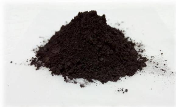
รูปที่ 3.2 ผงซิลิคอนที่ผ่านกระบวนการบดด้วยวิธี Ball milling
