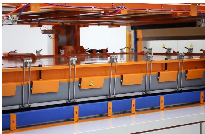
รูปที่ 4.15 การทำ Laminate แผงเซลล์แสงอาทิตย์ด้วยเครื่อง Laminator
