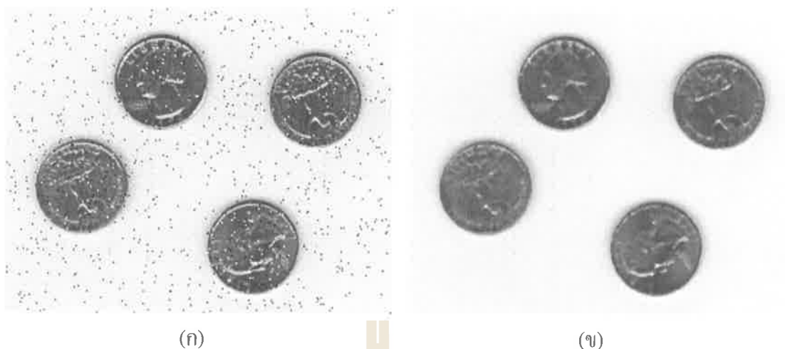
รูปที่ 2.18 แสดงตัวอย่างภาพที่ได้รับการปรับปรุงด้วยเทคนิค Nonlinear Filters โดยใช้ค่า Median ในการปรับปรุงภาพ โดยแสดง (ก) ภาพที่มีสัญญาณรบกวนชนิด Salt and Pepper, (ข) ภาพที่ได้รับการปรับปรุงด้วยเทคนิค Nonlinear Filters (ที่มา : MATLAB, Computer Program, 2016)
