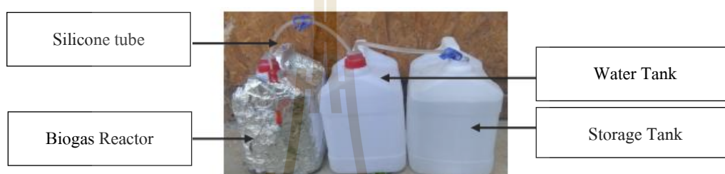
ภาพที่ 1 การทดลองแบบกะ ที่ effective volume 5 ลิตรระยะเวลาเก็บกัก 48 วัน และใน 1 เซตประกอบด้วย 3 แก้วกลอน : Biogas reactor, Water tank and Storage tank
