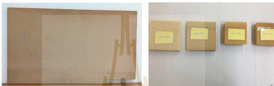
รูปที่ 3.2 วัสดุ (ซ้าย) PVC Foam H130 (ขวา) H100 และ H60
