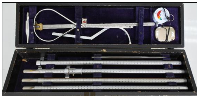
รูปที่ 3.1 เครื่องมือวัดสัดส่วนร่างกาย (Anthropometer)
