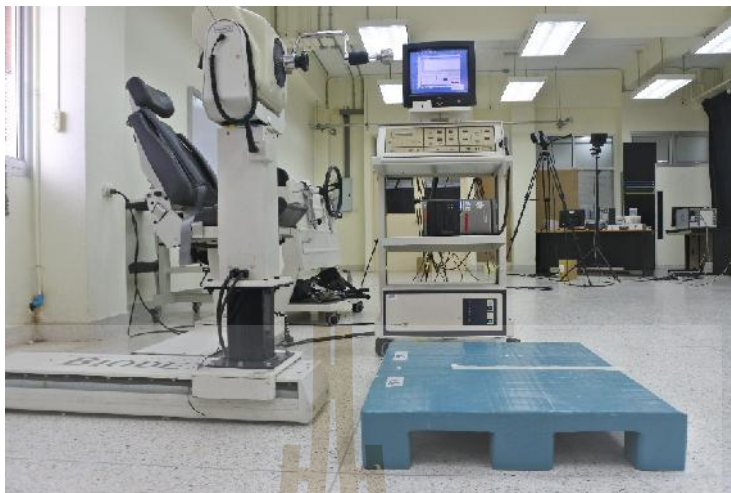
รูปที่ 3.4 การจัดตำแหน่งอุปกรณ์สำหรับทดสอบแรงบิดข้อมือ สำหรับทดสอบที่ระดับความสูง 100 110 120 และ 130 เซนติเมตร
