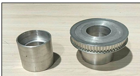
รูปที่ 3.4 ข้อต่อพวงมาลัยกับรอกตัวตามขนาด 60 ฟัน
