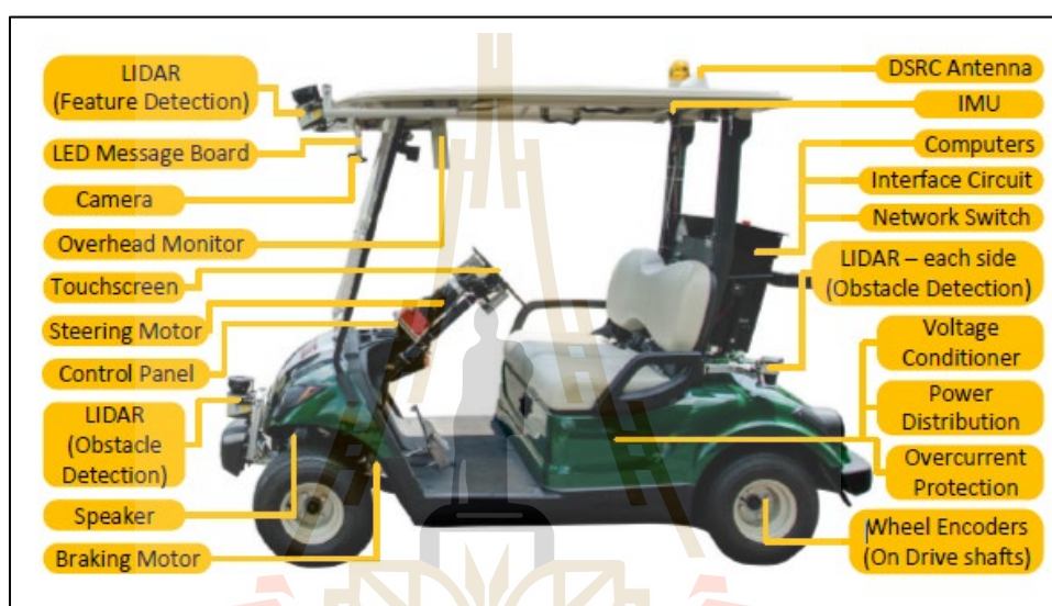
รูปที่ 2.6 รถกอล์ฟที่ถูกดัดแปลงให้สามารถใช้ระบบอัตโนมัติ (Scott et al., 2015)
