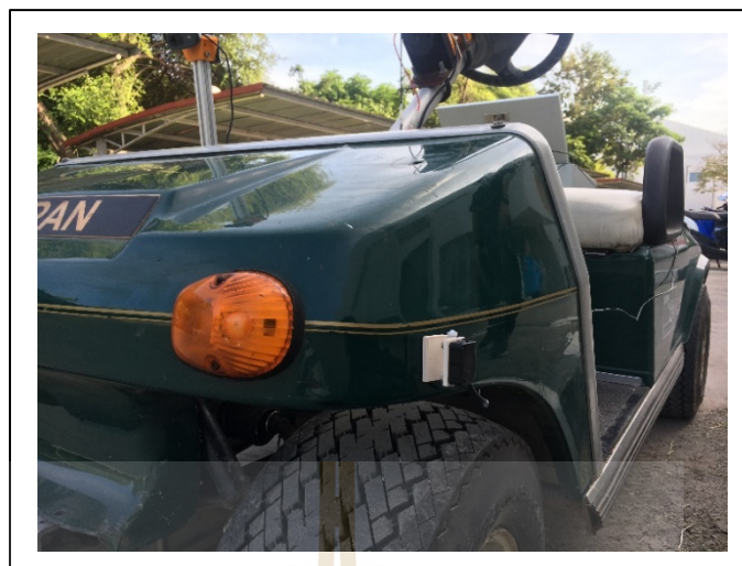
รูปที่ 3.22 การติดตั้งเซ็นเซอร์แสงที่ด้านข้างตัวรถ
