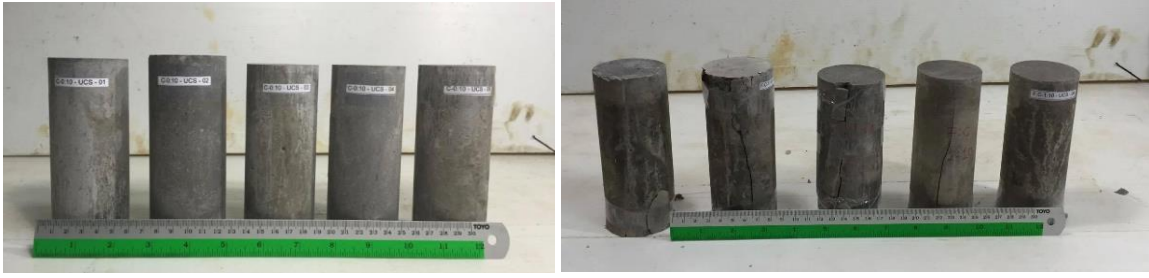
รูปที่ 4.2 ตัวอย่างบางส่วนจากการทดสอบกำลังรับแรงกดในแกนเดียวของส่วนผสมแก้ลอย (ซ้าย) ก่อนการทดสอบ (ขวา) หลังการทดสอบ
