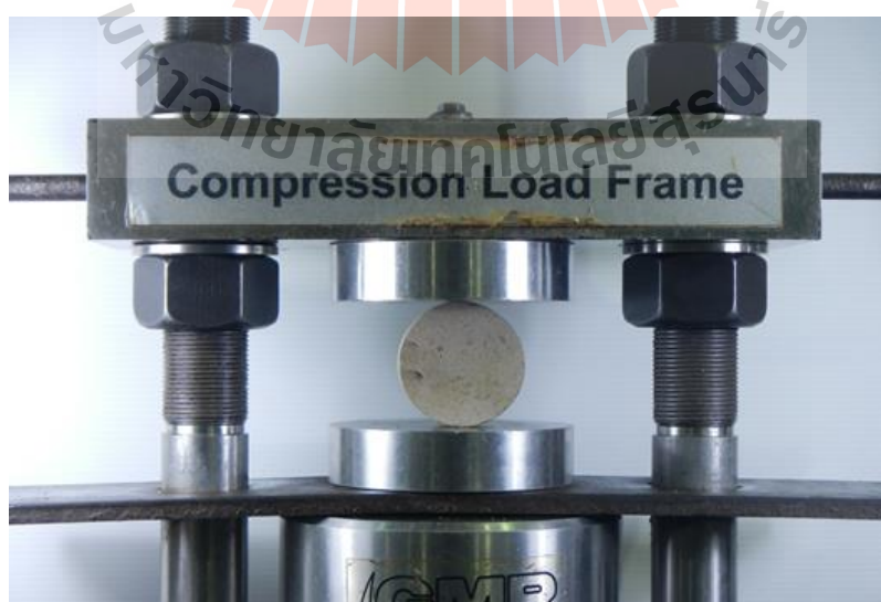
รูปที่ 4.6 การติดตั้งเครื่องมือการทดสอบแรงดึงแบบบราซิลเลียน ASTM D3967
