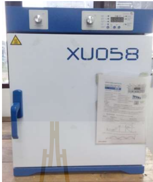
รูปที่ 3.2 ตู้อบความร้อนแบบลมร้อน (hot air oven)
