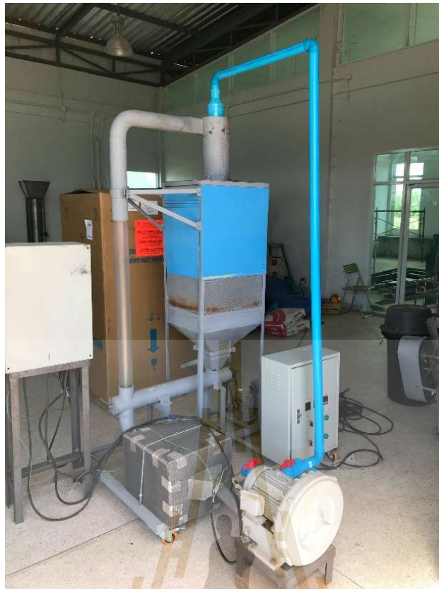
รูปที่ 4.12 ระบบอบแห้งแบบติดตั้งไซโคลนที่มีการนำอากาศร้อนหลังออกจากไซโคลนกลับมาผสมกับอากาศใหม่
