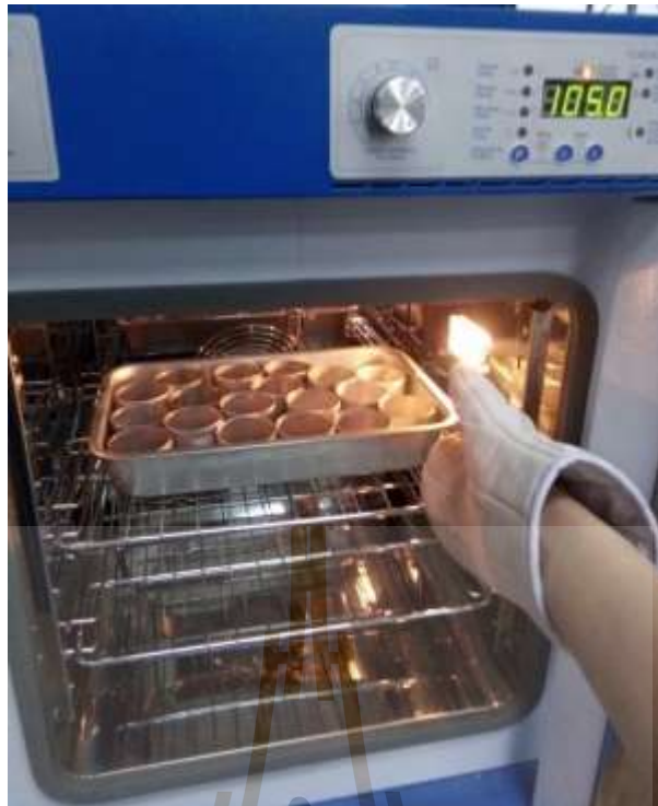
รูปที่ 3.11 การอบตัวอย่างข้าวเปลือกเพื่อหาความชื้นด้วยตู้อบลมร้อน
