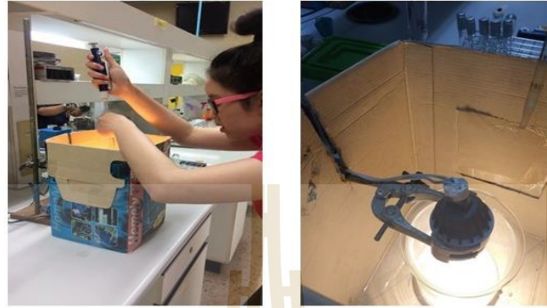
รูปที่ 4.5 แผ่นฟิล์มบางที่นำมาใส่ในน้ำที่มีเชื้อ แล้วจึงเปิดไฟจากหลอด UV
