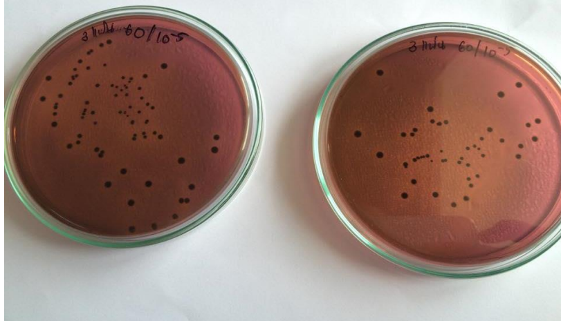
รูปที่ 4.14 แสดงจำนวนโคโลนี ของแผ่นฟิล์มบาง ZnO ที่อยู่ในช่วง 30-300 โคโลนี
