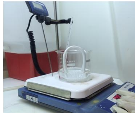
นำแผ่น Fused quartz มาใส่ปีกเกอร์ RCA1 ที่อุณหภูมิ 80 °C นาน 10 นาที
