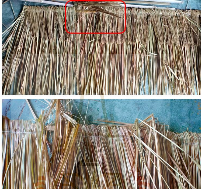
รูปที่ 4.12 ตัวอย่างของด้ายหญ้าที่เกิดปัญหาเย็บไม่สำเร็จ
