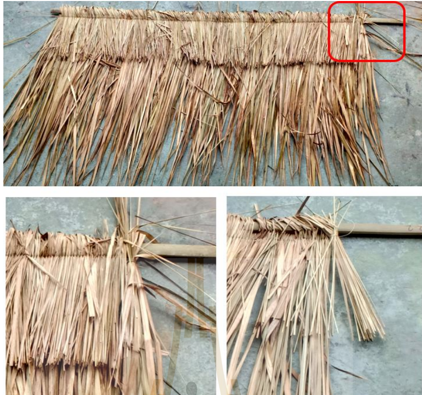
รูปที่ 4.10 ตัวอย่างของตับหญ้าที่เกิดปัญหาปลายการเย็บไม่สมบูรณ์
