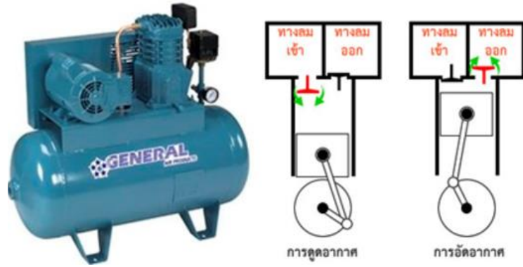
รูปที่ 2.7 เครื่องอัดอากาศแบบลูกสูบและการทำงาน (ณัฐพงษ์ จริตงาม และณิชา ลีเมจริญ, ม.ป.ป.)
