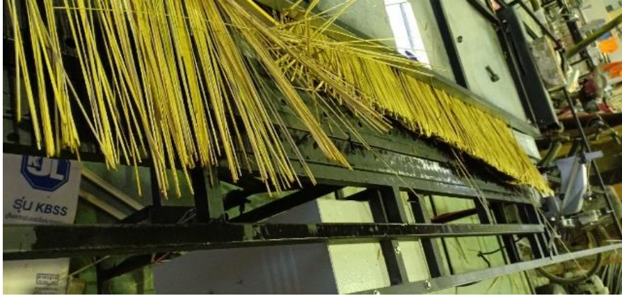
รูปที่ 4.13 ตัวอย่างที่เกิดปัญหาไม้หลุดจากชุดจับ
