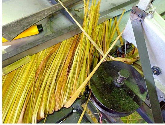
รูปที่ 4.2 การตัดของตบหญ้าที่บริเวณกลไกป้อนหญ้า
