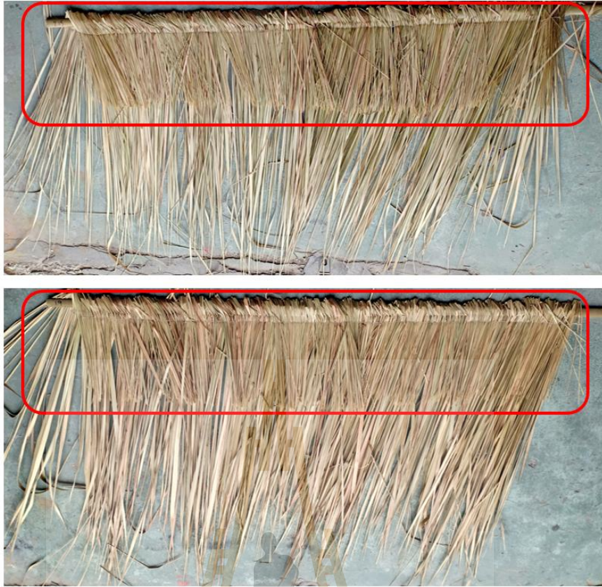
รูปที่ 4.9 ตัวอย่างของตับหญ้าที่เกิดปัญหาแนวพับของตับหญ้าเอียง
