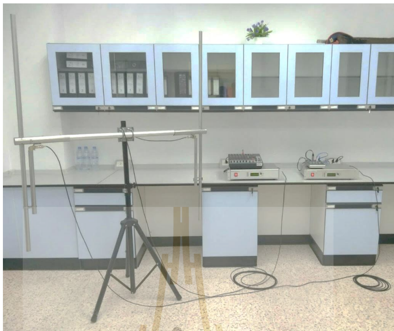
รูปที่ 5.2 อุปกรณ์จริงภาคส่งสัญญาณวิทยุในการจำลองการออกอากาศ
