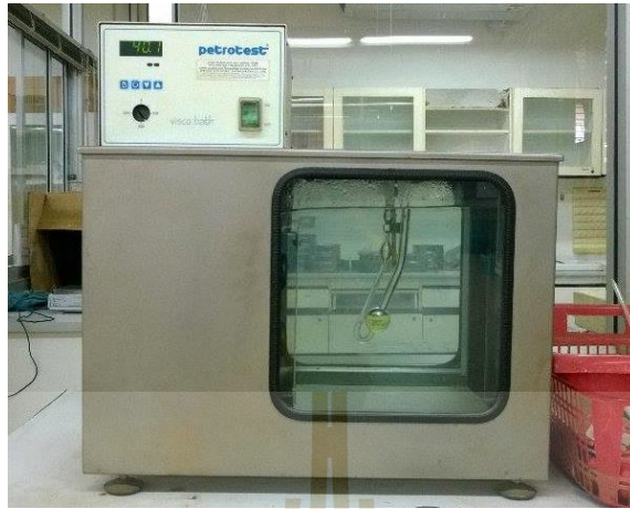
รูปที่ 2.5 เครื่องมือ Viscosity-Kinematic Capillary Tempering Bath High Temperature
