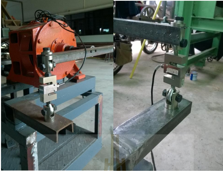
รูปที่ 3.20 โหลดเซลล์ (Load Cell) สำหรับวัดค่าแรงบิด
