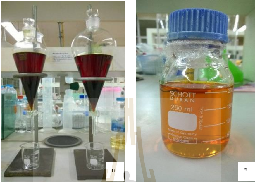
รูปที่ 3.2 การผลิตไบโอดีเซลจากน้ำมันปาล์มดิบ (ก) การแยกชั้นของน้ำมันไบโอดีเซลและกลีเซอรอล (ข) น้ำมันไบโอดีเซลจากน้ำมันปาล์มดิบ
