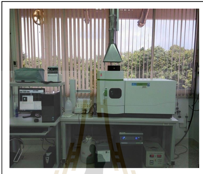
รูปที่ 3.3 เครื่อง Inductively Coupled Plasma - Optical Emission Spectrometry (ICP-OES) ณ ศูนย์เครื่องมือวิทยาศาสตร์และเทคโนโลยี (F10)
