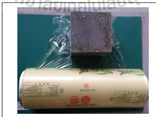
รูปที่ 3.14 การบ่มชิ้นทดสอบด้วยพลาสติก
