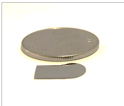
รูปที่ 3.14 ชิ้นงานตัวอย่างที่ผ่านขัดหยาบและละเอียด
