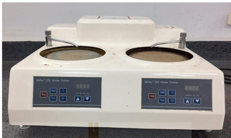
รูปที่ 3.6 เครื่องขัดกระดาษทรายจานหมุน
