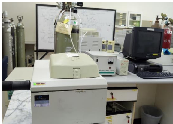
รูปที่ 3.8 เครื่อง differential scanning calorimeter รุ่น Pyris Diamond DSC (USA)
