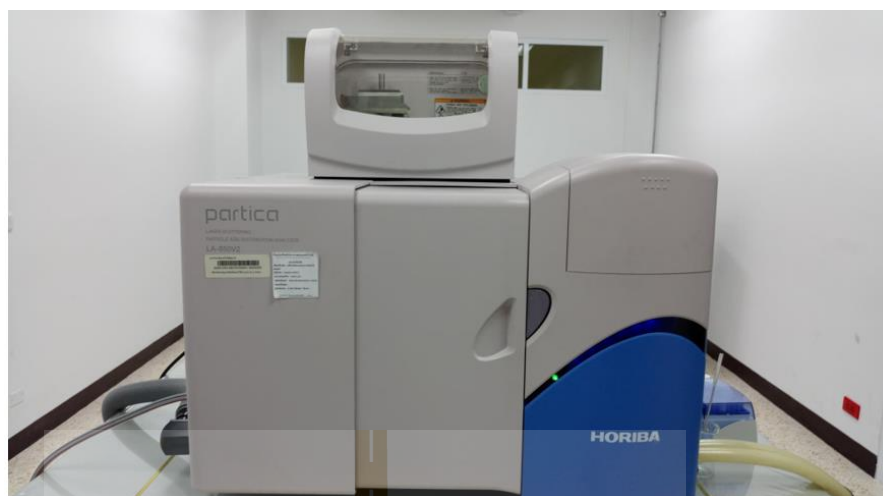
รูปที่ 3.6 เครื่อง Particle size distribution analyzer รุ่น LA-9502v (Horiba Kyoto, Japan)
