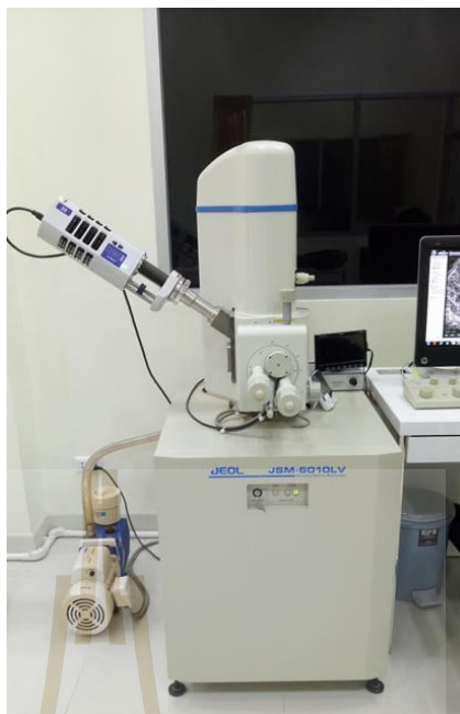
รูปที่ 3.7 เครื่อง scanning electron microscope (SEM) รุ่น JSM6010LV (JEOL, Tokyo, Japan)
