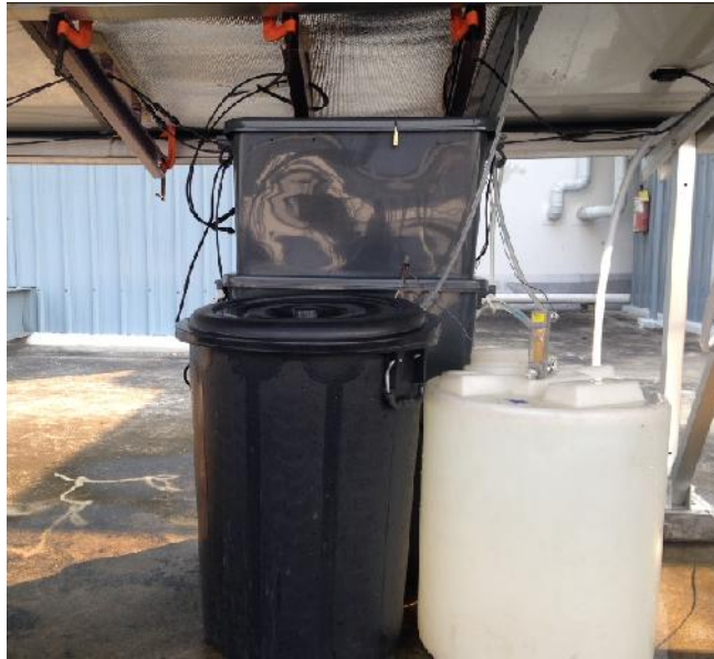
รูปที่ 3.7 แผงรับความร้อนและชุดทดลองติดตั้งบริเวณคานฝ้า
