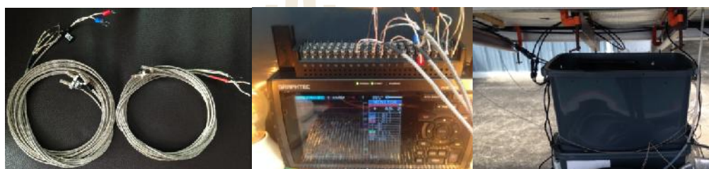
รูปที่ 3.9 Thermocouple Type K การต่อเข้าเครื่องบันทึกและการติดตั้ง
