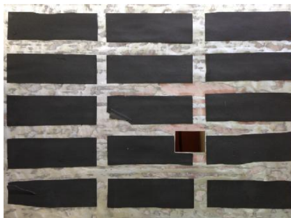
รูปที่ 3.4 แผงรับความร้อนที่มีแผ่นความร้อน (Thermal Pad) ติดผสาน
