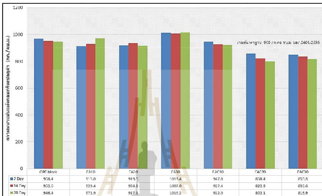
รูปที่ 4.2 ผลการทดสอบความหนาแน่นแห้งของลัดส่วนผสมต่าง ๆ คอนกรีตเซลลูโลส อายุ 7, 14 และ 28 วัน
