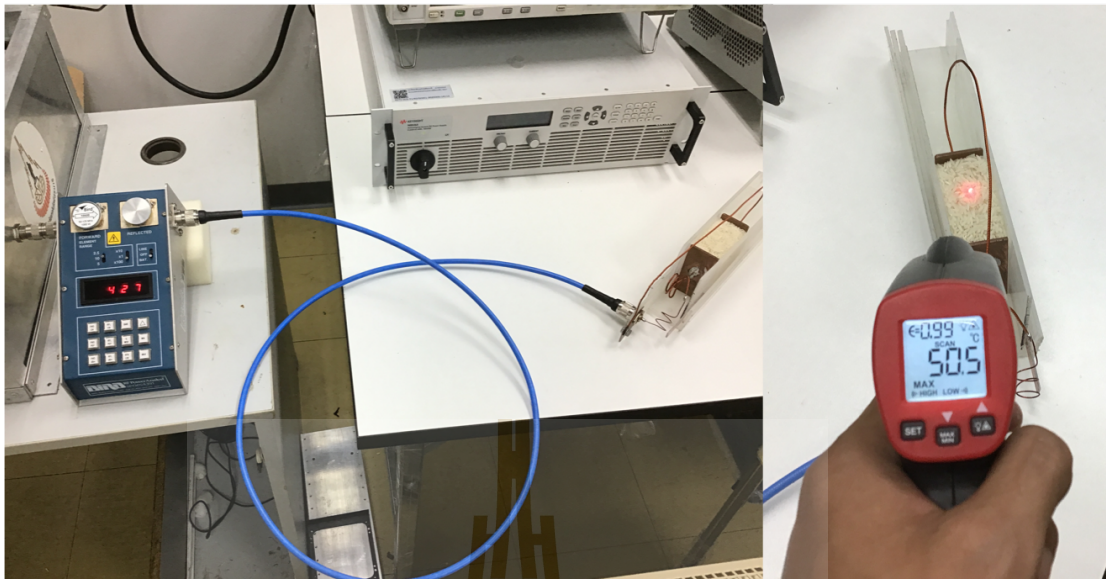
รูปที่ 4.24 การทดสอบเฟลต (ซ้าย) ชุดทดสอบ RF power amplifier และเฟลต (ขวา) วัดความร้อนของขั้วในเฟลต
