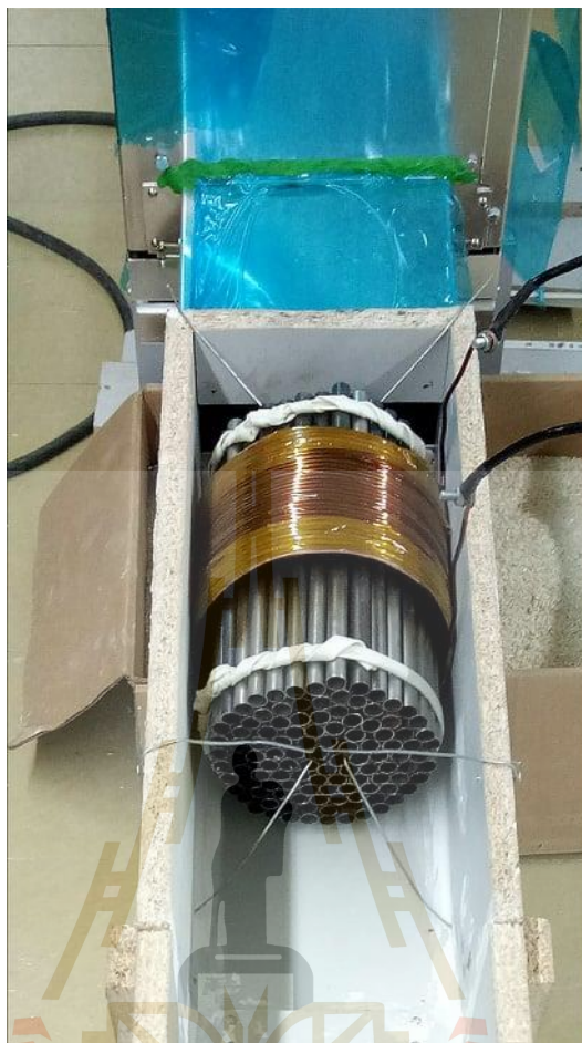
รูปที่ 3.12 ชุดโหลดความร้อนที่สร้างขึ้นและลักษณะการวางตัวของขดลวดเหนี่ยวนำกับชิ้นงานโลหะ
