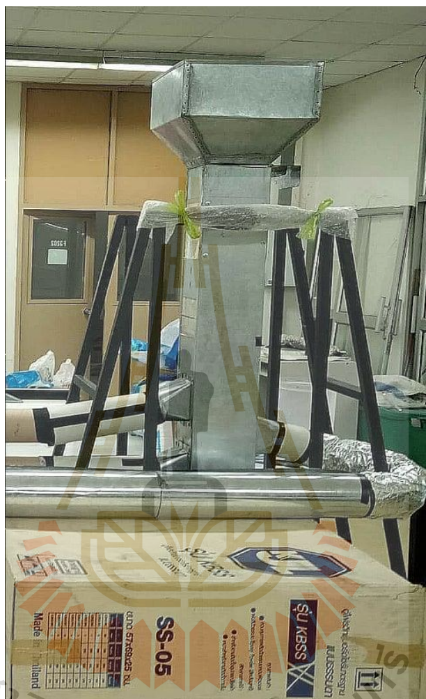
รูปที่ 3.13 เครื่องให้ความร้อนสำหรับเมล็ดข้าวที่มีอยู่ในห้องปฏิบัติการ
