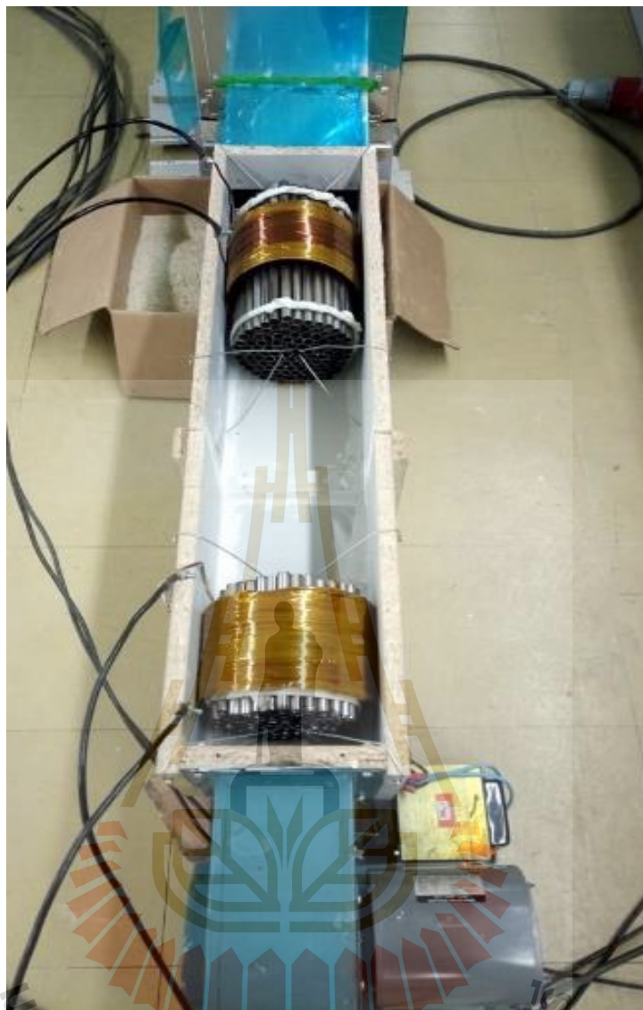
รูปที่ 3.22 ชุดโหลดความร้อนของวงจรไฟฟ้าเหนี่ยวนำทั้ง 2 ชุดที่ใช้เป็นแหล่งกำเนิดความร้อน
