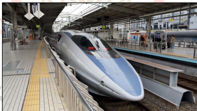
(ข) รูปทรงของรถไฟฟ้าที่ถูกออกแบบมาเพื่อลดแรงต้านอากาศ
