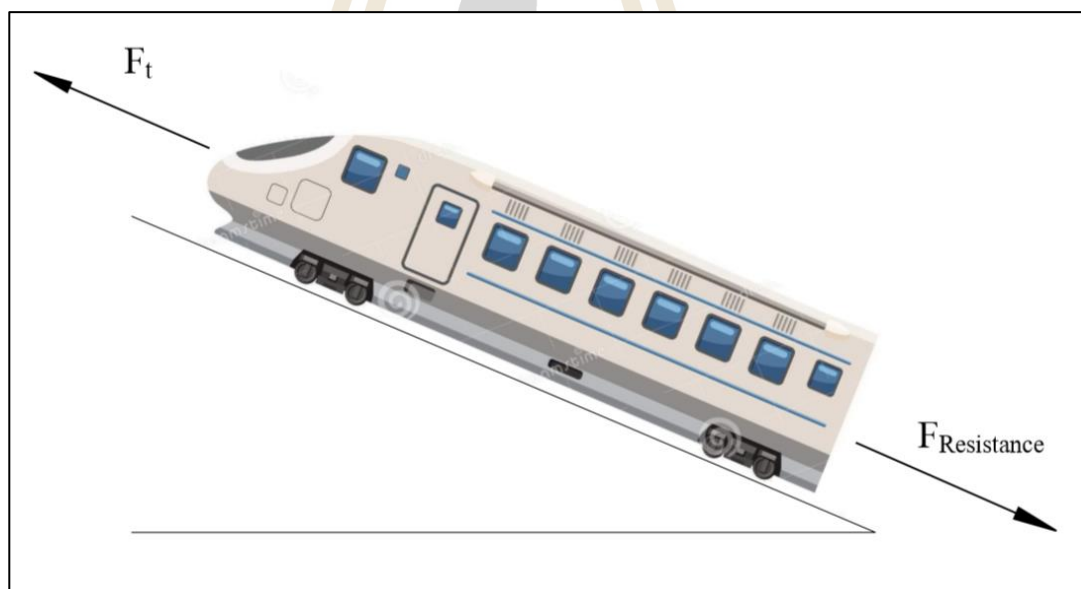
รูปที่ 2.31 Free body diagram ของรถไฟฟ้า
