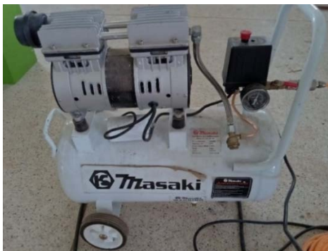
รูปที่ 3.16 ปัมลม (Air compressor)
