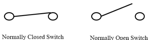
รูปที่ 2.25 แสดงสัญลักษณ์ของสวิตช์แบบปกติปิด และแบบปกติเปิด
