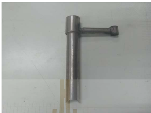
รูปที่ 4.10 แสดงลักษณะของหัวคว้านเมล็ดงาสำหรับกลไกคว้านเมล็ดงา
