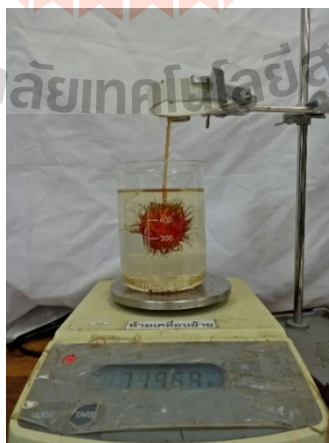
รูปที่ 3.3 การหาค่าความถ่วงจำเพาะของผลเงาะ
