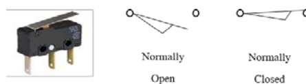
รูปที่ 2.29 แสดงลักษณะของ Limit Switch และ สัญลักษณ์ของ Limit Switch
