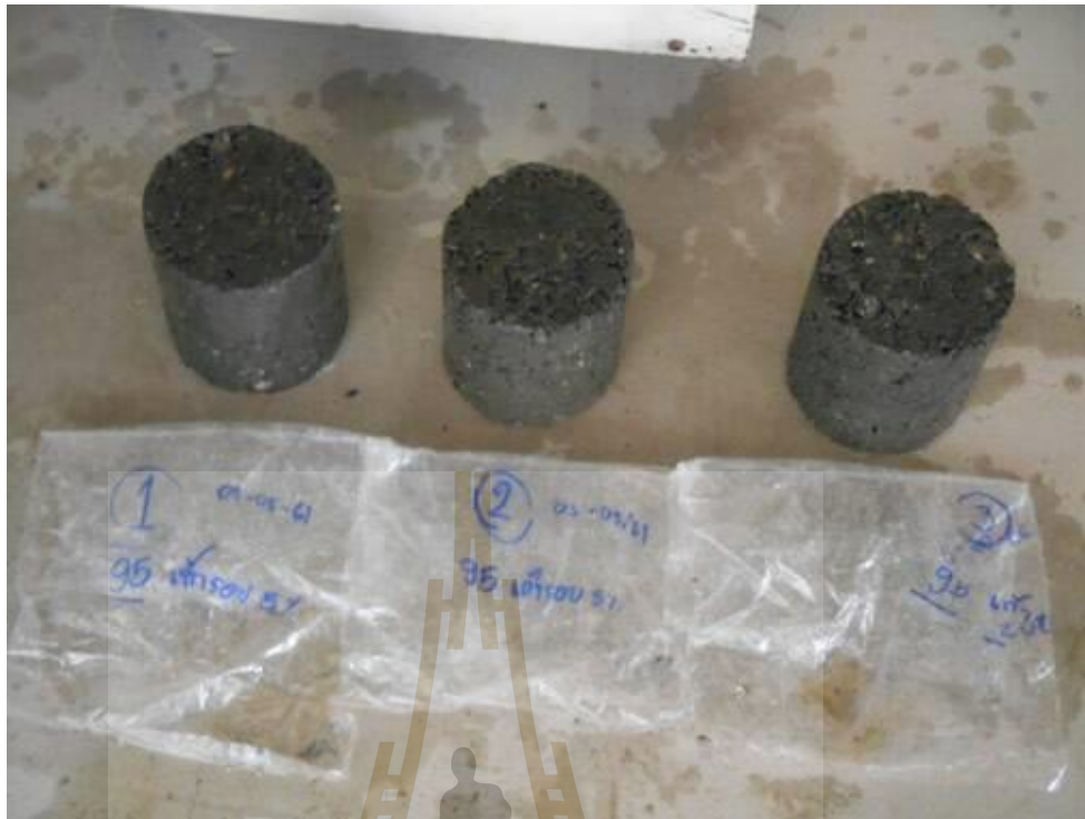
รูปที่ ก.11 การบ่มแห้งตัวอย่างในสัดส่วน 85 : 15 (ชุดตัวอย่างละ 9 ก้อน)
