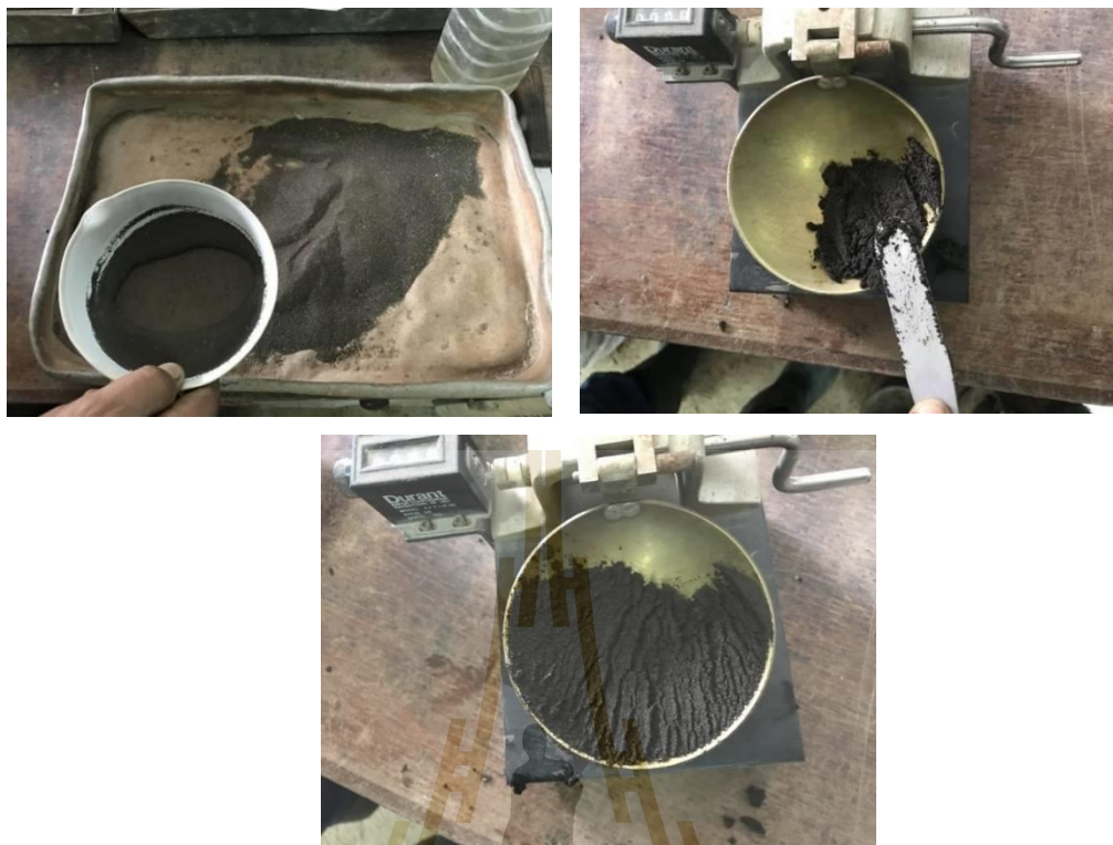
รูปที่ 3.4 การทดลองหาค่าขีดจำกัดเหลว
