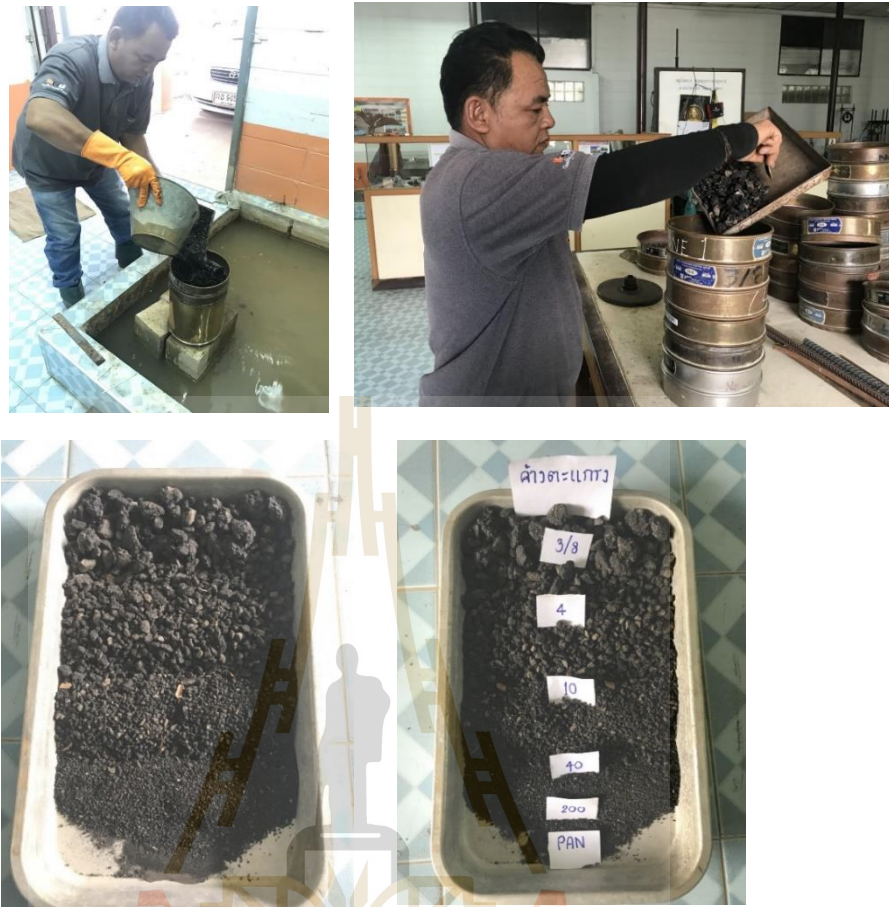
รูปที่ 3.3 การทดลองเพื่อหาขนาดเม็ดของวัสดุ
