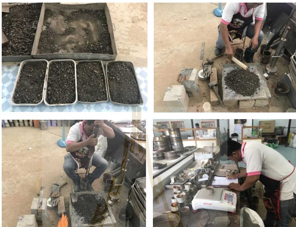
รูปที่ 3.8 การทดลองการบดอัดแบบสูงกว่ามาตรฐาน
