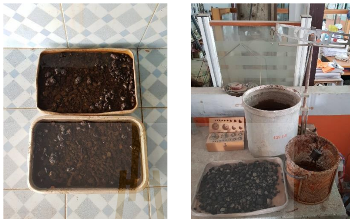
รูปที่ 3.6 การทดลองเพื่อหาค่าความถ่วงจำเพาะ
