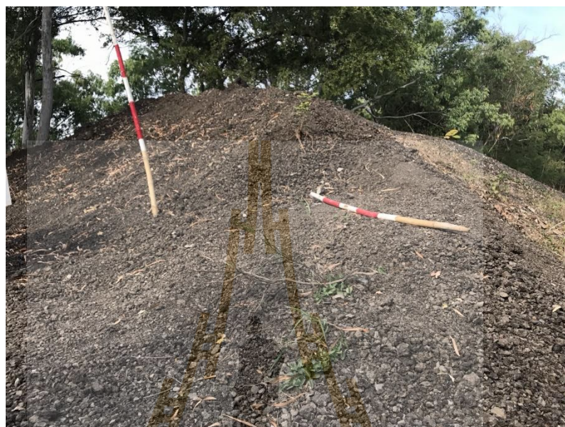
รูปที่ 2.1 วัสดุรวมรวมผิวทางแอสฟัลต์คอนกรีตเก่า (RAP) จากหมวด การทางนครราชสีมาที่ แขวงทางหลวงนครราชสีมาที่ 1
