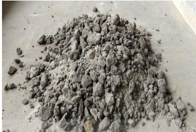
รูป 3.10 การผสมวัสดุปรับปรุงผิวทางแอสฟัลต์คอนกรีตเก่า
