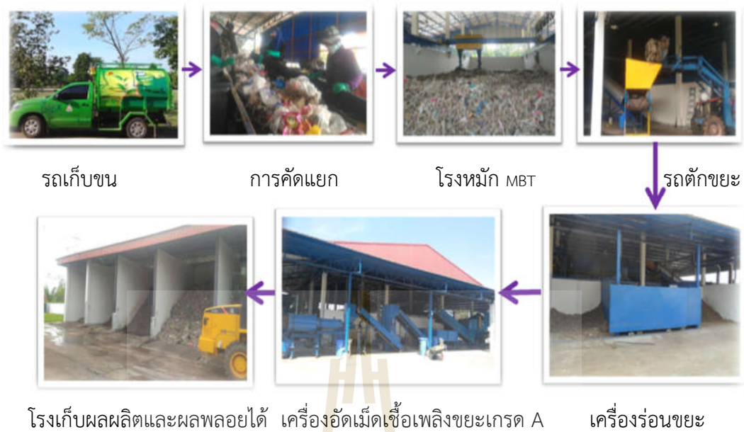
ภาพที่ 4.10 การปฏิบัติงานภายในโรงจัดการขยะแบบครบวงจร
