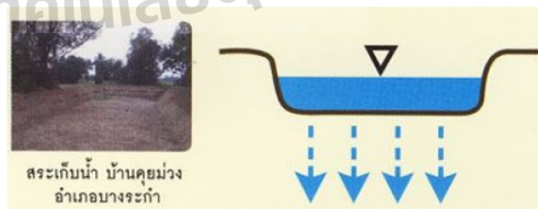
รูปที่ 1 การเติมน้ำผ่านสระ (Recharge Pond) ที่มา : [2]
