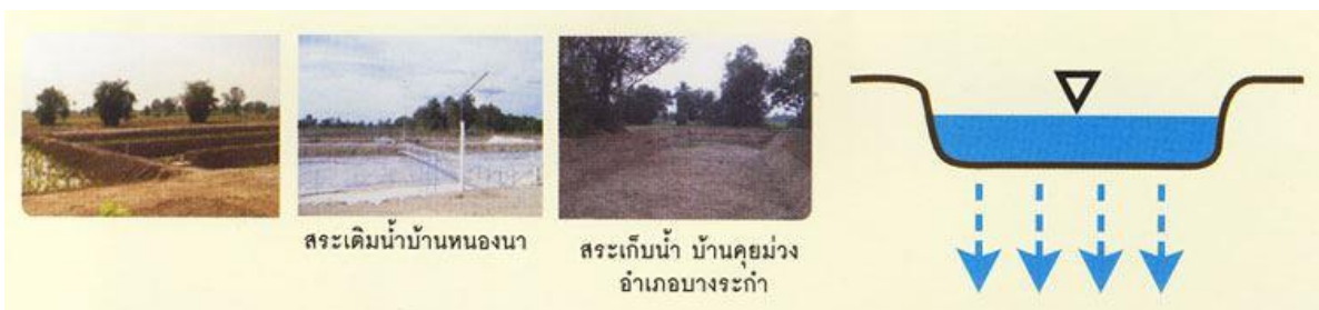
รูปที่ 2.1 การเติมน้ำใต้ดินระดับต้นผ่านสระเติมน้ำ (กรมทรัพยากรน้ำบาดาล, 2561)
