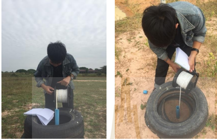
รูปที่ 3.15 วิธีการเก็บค่าระดับน้ำด้วยเครื่องมือวัดระดับน้ำ
