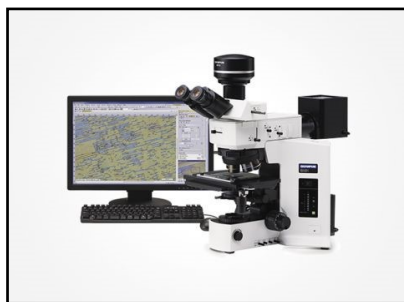
รูปที่ 4.27 เครื่องมือวิเคราะห์และประมวลผลภาพถ่าย Olympus รุ่น BX51M
