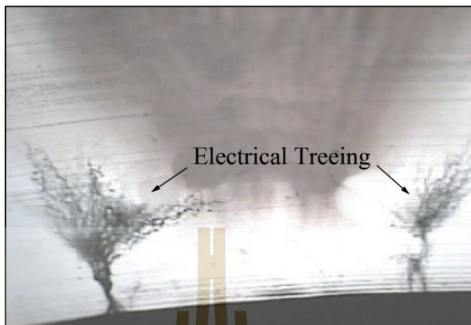
รูปที่ 2.16 รูปขยายจากรูปที่ 2.13 ทริอิงทางไฟฟ้าที่งอกออกมาจากฐานของวอเตอร์ทริอิง (Mashikian, 2006 อ้างอิงใน ชีระพงษ์, 2557)
