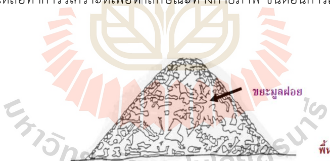
รูปที่ 2.11-1 ลักษณะการกองขยะมูลฝอยให้เป็นรูปกรวยก่อนที่จะแบ่งขยะมูลฝอยออกเป็น 4 ส่วน
