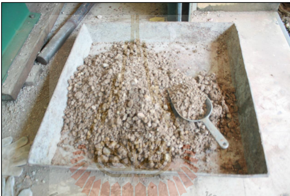
รูปที่ 3.2 ลักษณะทางกายภาพของวัสดุมวลรวมดิน (Soil Aggregate)
